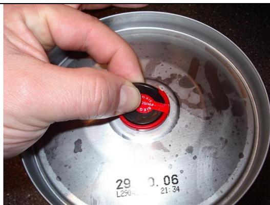
Der Entlüftungshebel wird angehoben und einfach nach oben abgerissen. Dabei nicht drehen!
