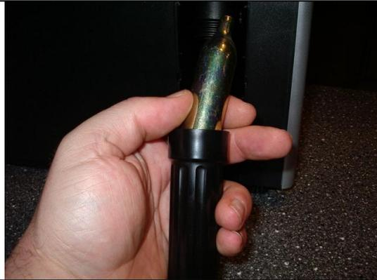
Danach die Kohlendioxidpatrone wechseln. Zuerst den Regler an der Vorderseite auf null drehen, dann die alte Patrone herausnehmen. Eine neue Patrone einsetzen und die Halterung handfest andrehen.
