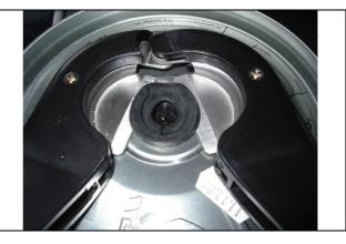
Nachdem der Verschluß getrennt ist, kann man die untere Hälfte mit Hilfe des orangenen Universalstopfens in das Faß drücken.
