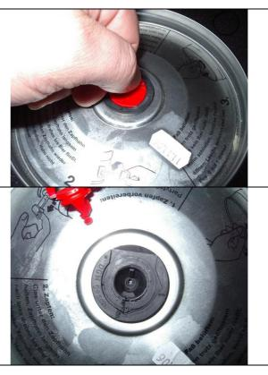
Nun kommt das mitgelieferte Werkzeug zum Einsatz, mit dem der Gummiverschluß in der Hälfte getrennt wird.
